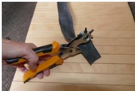
8. Für Dorn mit Lochzange/Locher lochen
