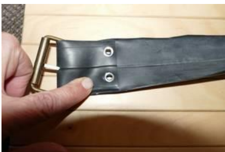
13. Ösen mit Ösenzange anbringen
