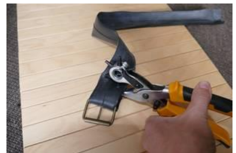
12. Mit Lochzange/Locher lochen
